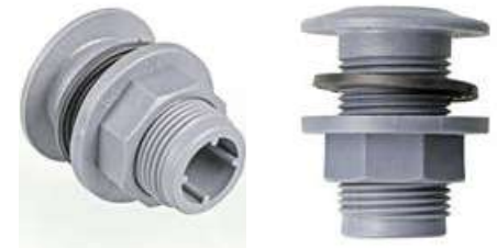
Conexión de recipiente con rosca exterior, completa con juntas de EPDM, para un fácil montaje de rosca en las paredes del recipiente.
